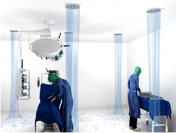
Traditionelle Zuluft Decken wirken nur sehr punktuell, da die Asepsis nur direkt unter dem Luftauslass gegeben ist.
