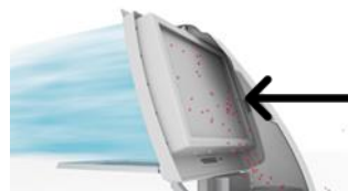
Ansaugung und Filterung der Umgebungsluft
